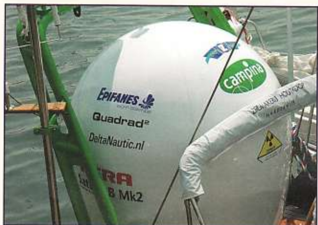
De radome van de Nera satcom installatie
